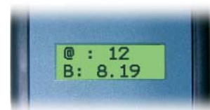
Tension pile et numéro boîtier.
